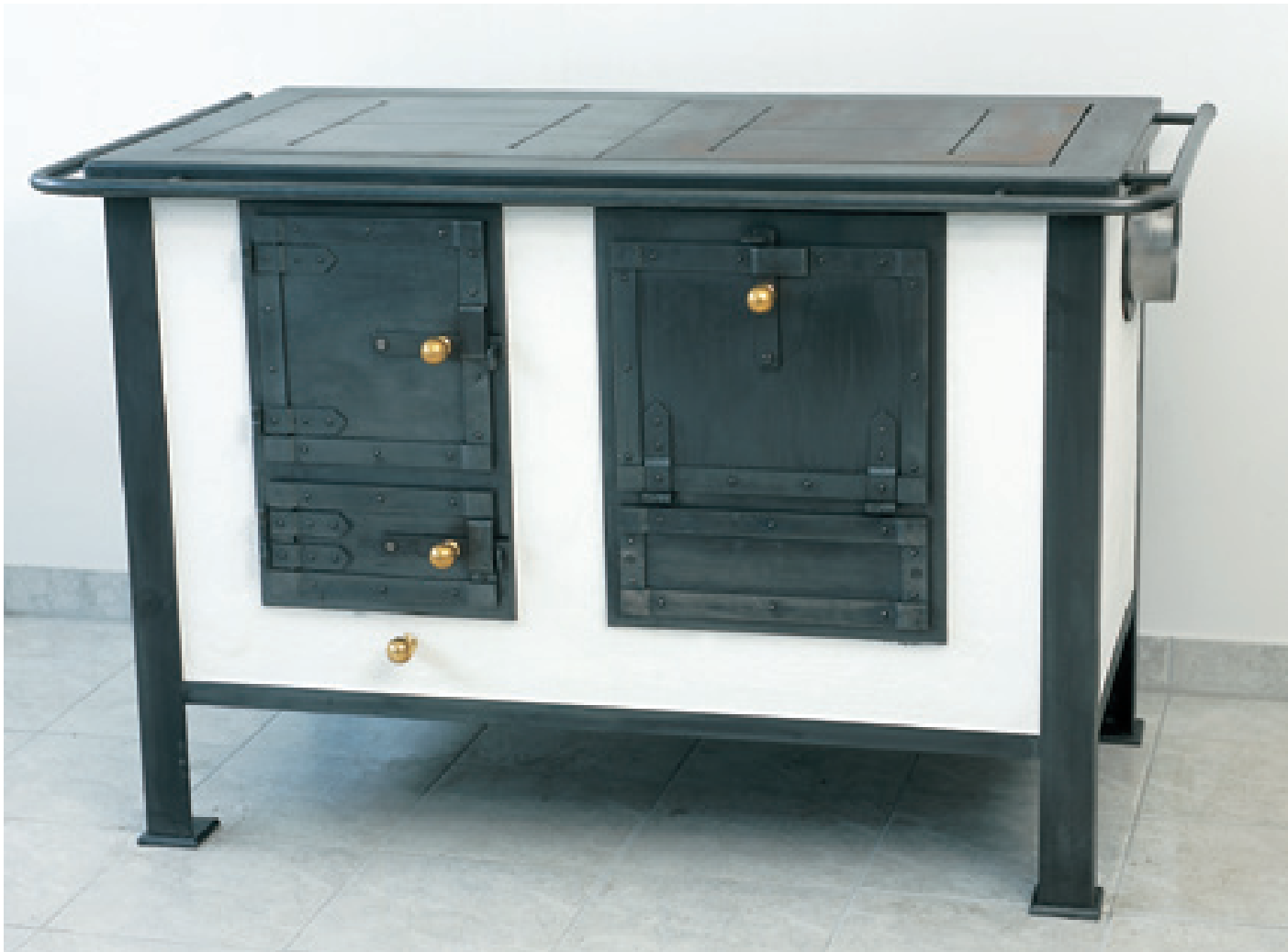
Abb.: Modell Rustikal, Küchenherd mit Feuer-Asche-Geschränk, Bratröhre mit Falltüre, alle Teile einbrenngraphitisiert geschwärzt, Knöpfe in Messing
