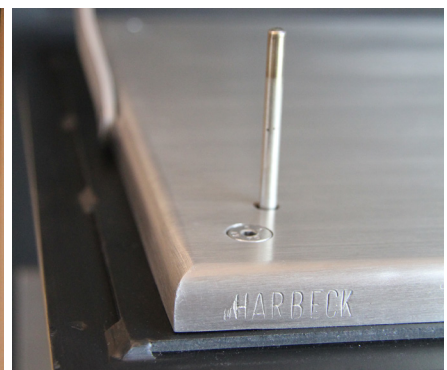
Abb.: Fühler des Durchsteck-Thermometers (Innenseite Türe)
